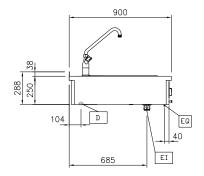
FΙ Electrical inlet (power) Equipotential screw EQ
